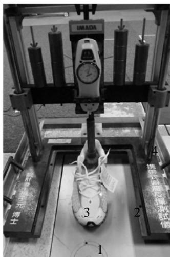
圖 2 儀器示意圖（1.測力板 2.反彈測試儀 3.測試鞋 4.撞擊器固定架）
